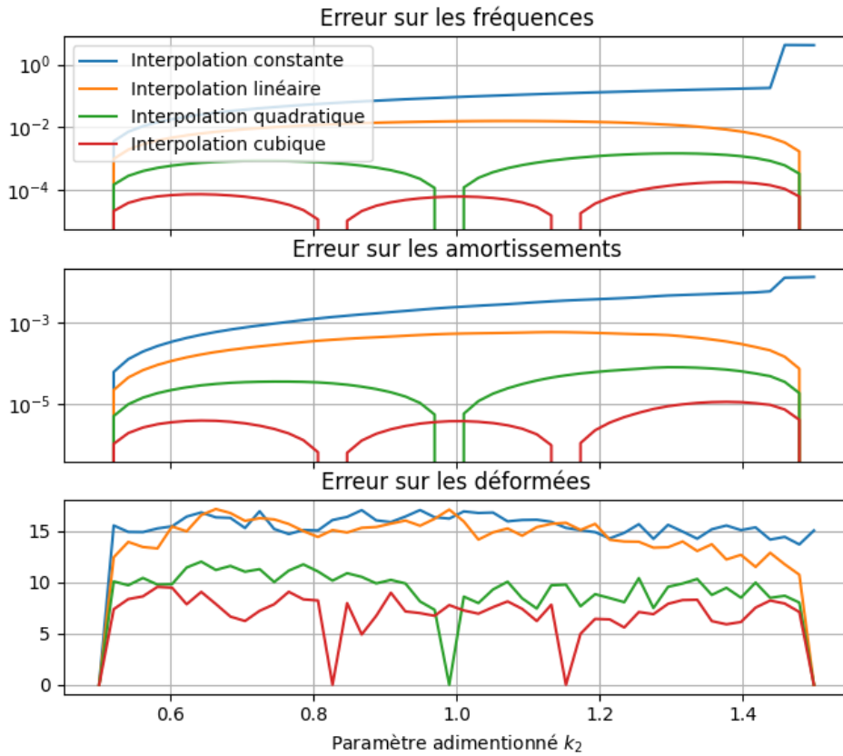
FIGURE 5 – Erreur entre les couplages modal et reconstitué en fonction du type d'interpolation.
