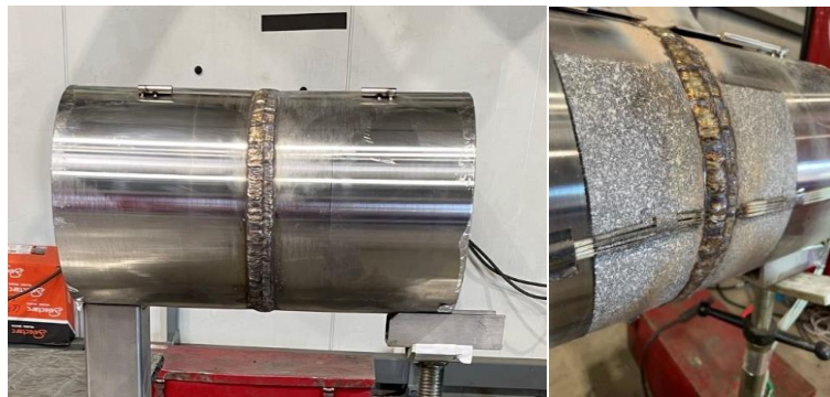
Figure 3 – Maquette de tuyau en acier austénitique avec instrumentation par thermocouples et mouchetis pour l'analyse de corrélation stéréoscopique.
